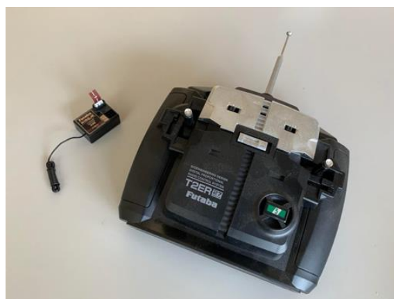
市售 3 通道 27MHz 板型遙控收發器
