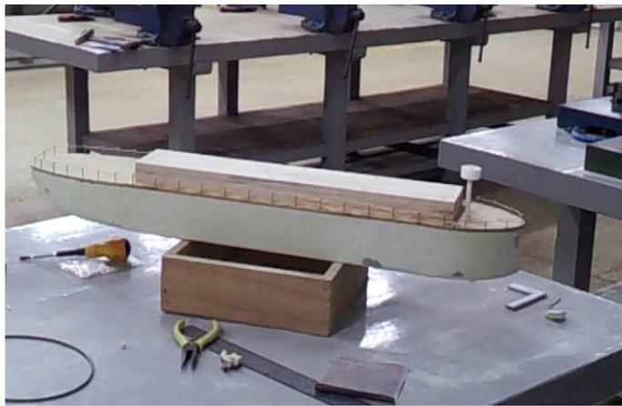
圖 5-2 整個船身補土及甲板
